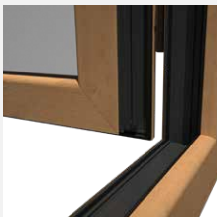
Coupe d'une menuiserie placée ton bois chêne irlandais 2 faces
